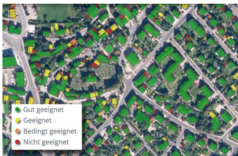
Die für Solarenergie wirtschaftlich geeigneten Dächer werden im Solarrechner grün bzw. gelb eingefärbt). Das Bild zeigt einen Ausschnitt der Stadt Pegnitz. © tetraeder.solar
