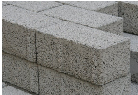
Abbildung 7: Porenpflastersteine lassen Wasser durch den Beton versickern. Quelle: Michael Wolf, commons.wikimedia.org
