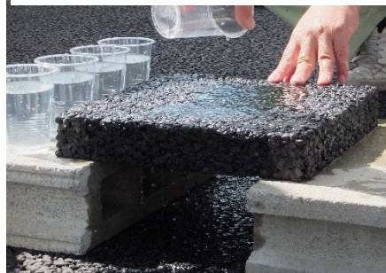
Abbildung 9: Dränasphalt bei einem Durchlässigkeitsversuch.
