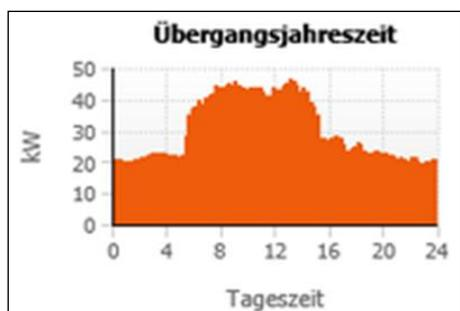
Abb. 2 : Tageslastprofil Rest-Bedarf Strom von 0-24h in der Übergangszeit
