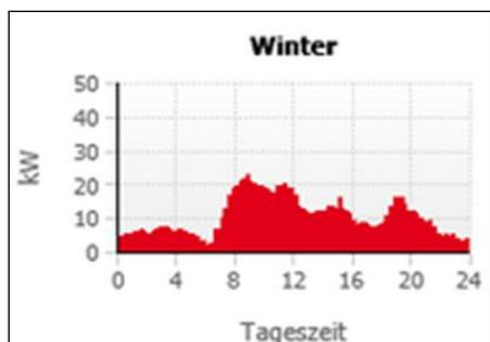
Abb. 3 : Tageslastprofil Rest-Bedarf Strom von 0-24h im Winter
