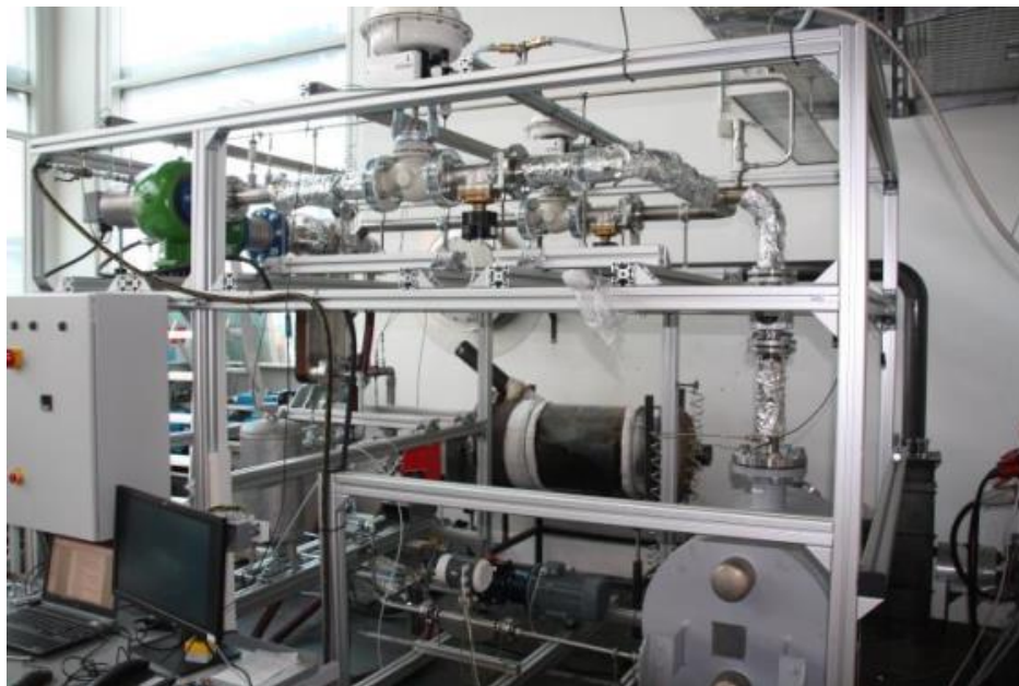
Abb. 2: Ansicht der aufgebauten Mini-ORC-Versuchsanlage
