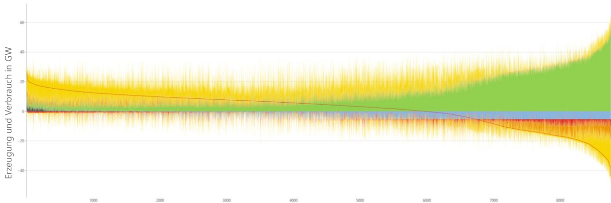
Abbildung 6-5: Stündliche Stromerzeugung, Residuallast und Stromverbrauch flexibler Verbraucher 62
